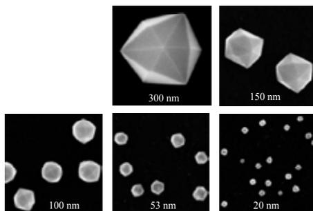
二十四面体晶体及其表面原子排列结构模型。电化学制备的二十四面体铂纳米粒子的透射电镜照片(300nm)，和负载到导电炭基底上不同粒径(150, 100, 53, 20nm)的二十四面体铂纳米粒子的扫描电镜图像
